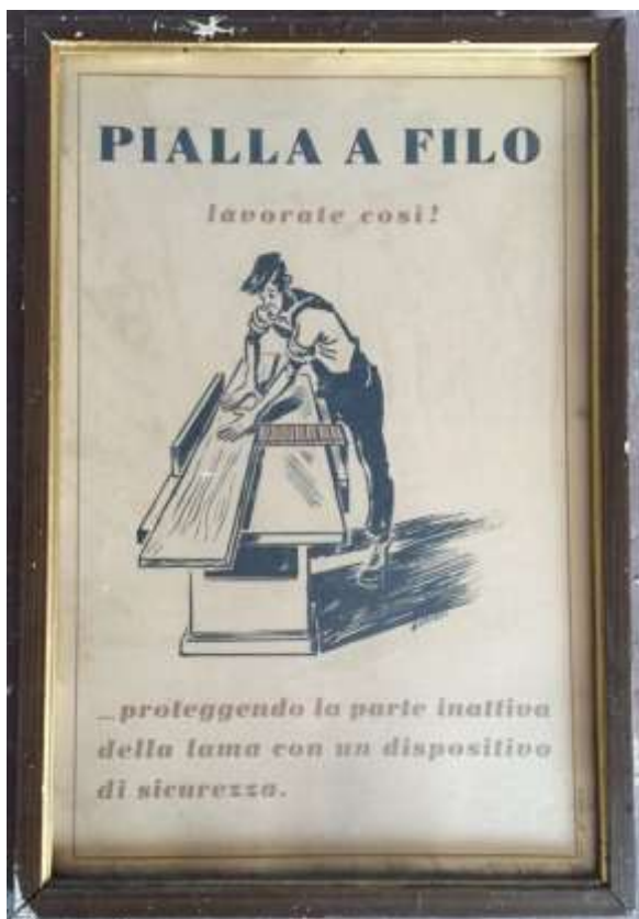
PIALLA A FILO lavorate così' ... proteggendo la parte inattiva della lama con un dispositivo di sicurezza
